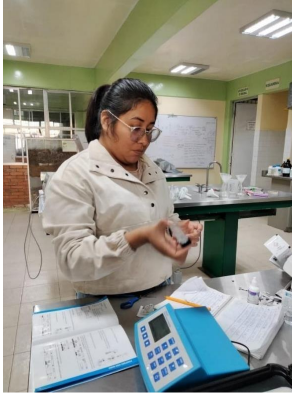
Ilustración 21. Agitación del reactivo de fósforo para lectura de fotómetro
