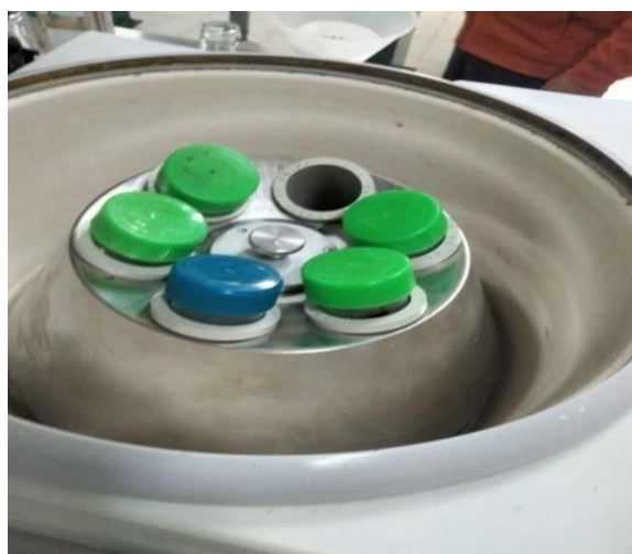
Ilustración 18 Tubos cónicos en la centrifugadora para comenzar las revoluciones.
