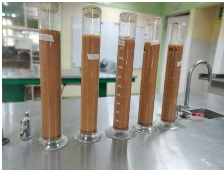
Ilustración 24 Probetas con muestras de suelo para identificar textura.
