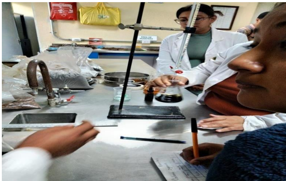
Ilustración 16 Titulación del sulfato ferroso para determinar Carbono Orgánico.
