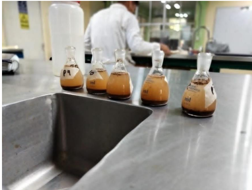
Ilustración 25 Picnómetros con muestras de suelo para determinar densidad real.
