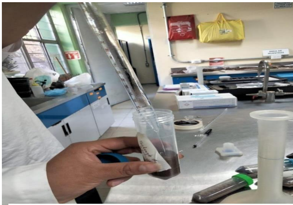
Ilustración 17 Muestra de suelo en tubo cónico de 50 ml agregándole agua destilada.
